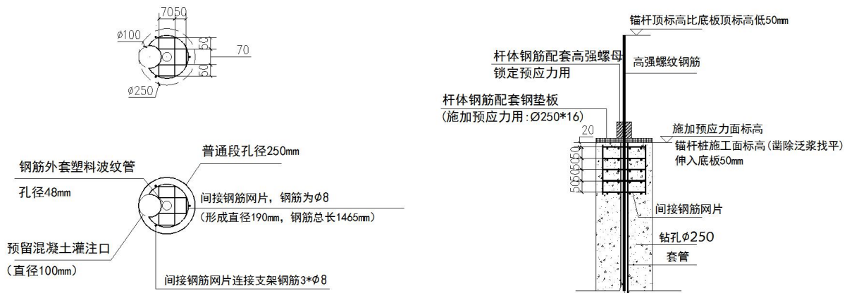
图 5.1 间接钢筋配置图
